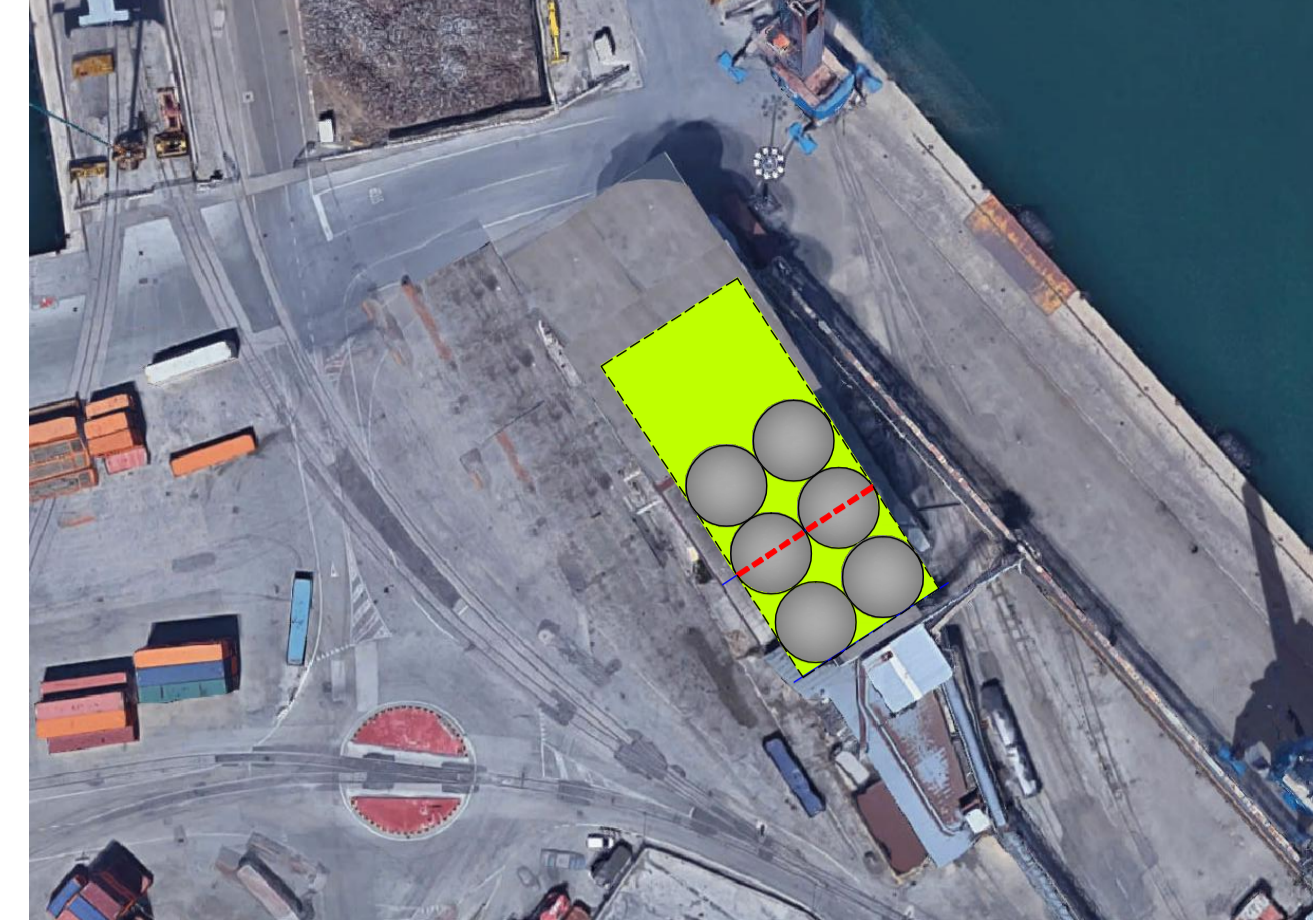
PROIEZIONE FISICA GEOMETRICA CROLLO SILOS
