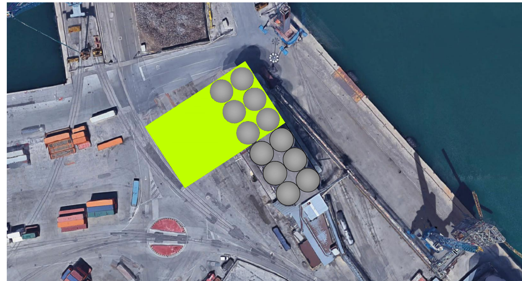
PROIEZIONE FISICA GEOMETRICA CROLLO SILOS
